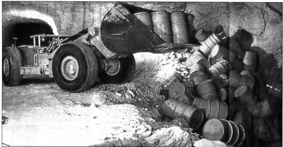
Mit einem Radlader wurden im Asse-Schacht Atom-Fässer in einer Kammer abgekippt.
